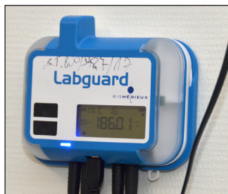
system monitoringu temperatury i wilgotności powietrza
