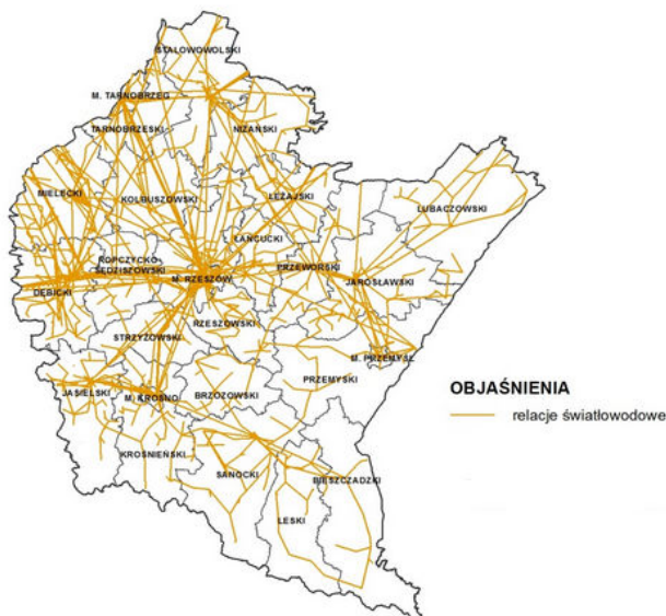
Rysunek 2. Stan światłowodowych linii informatycznych podwieszanych na liniach NN i SN w województwie podkarpackim
