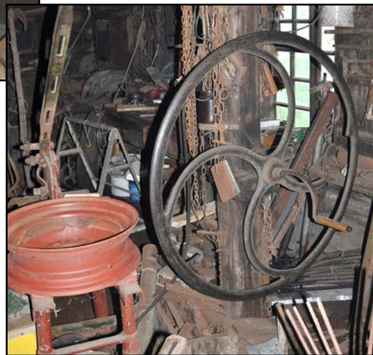
Ręcznie obracane koło napędzające ponad 100-letnią wiertarkę
