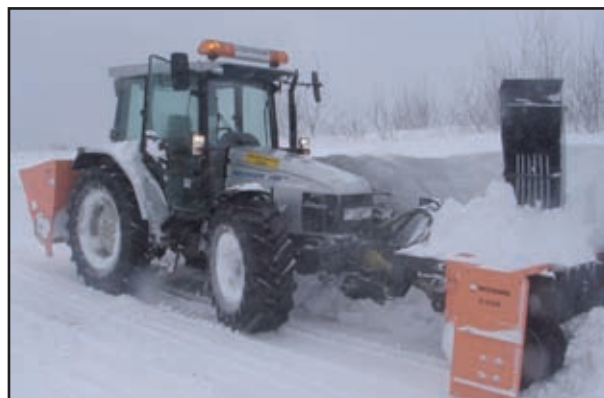
Przy dużych opadach śniegu wykorzystywana jest dmuchawa
